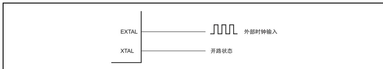
图 4.4 外部时钟的连接例子
