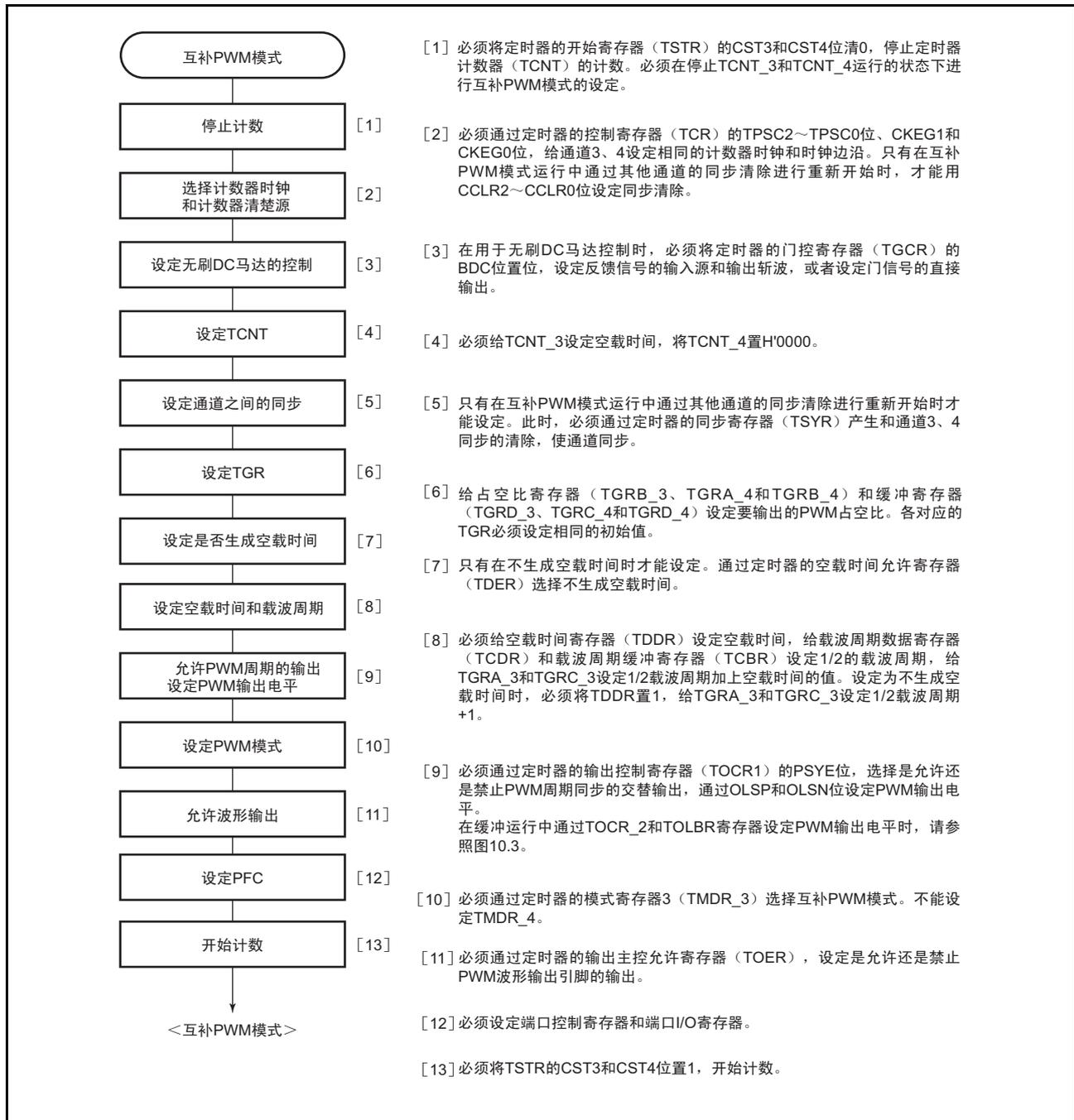
图 10.38 互补 PWM 模式的设定步骤例子
