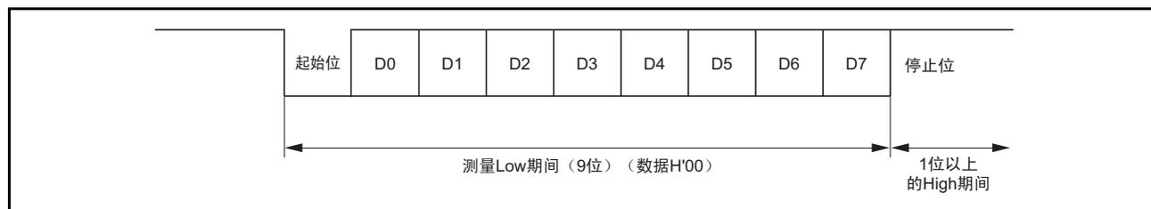
图 19.7 SCI 位速率的自动匹配
