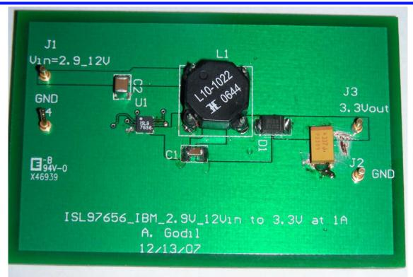
FIGURE 2. ISL97656 SEPIC TEST BOARD - FRONT SIDE
