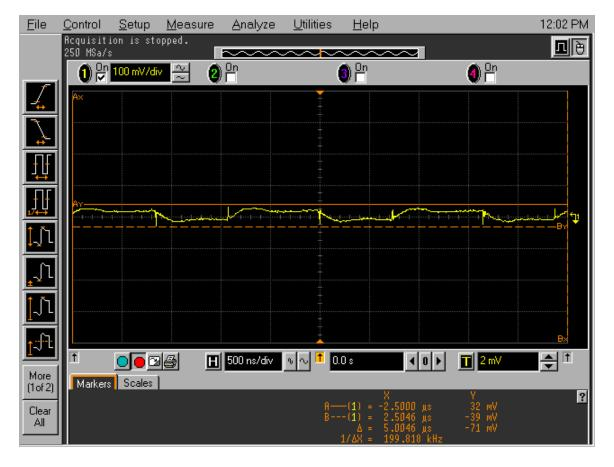
FIGURE 6. ISL97656 SEPIC BOARD OUTPUT VOLTAGE RIPPLE FOR 12VIN TO 3.3V $_{
