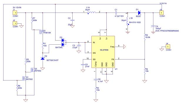
FIGURE 1. ISL97656 SEPIC SCHEMATIC FOR 3V to  $12V_{\text{IN}}$  TO  $3.3V_{\text{OUT}}$  AT 1A
