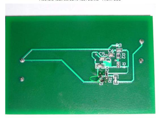
FIGURE 3. ISL97656 SEPIC TEST BOARD - BACK SIDE
