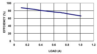
FIGURE 5. ISL97656 SEPIC BOARD EFFICIENCY FROM 3VIN
