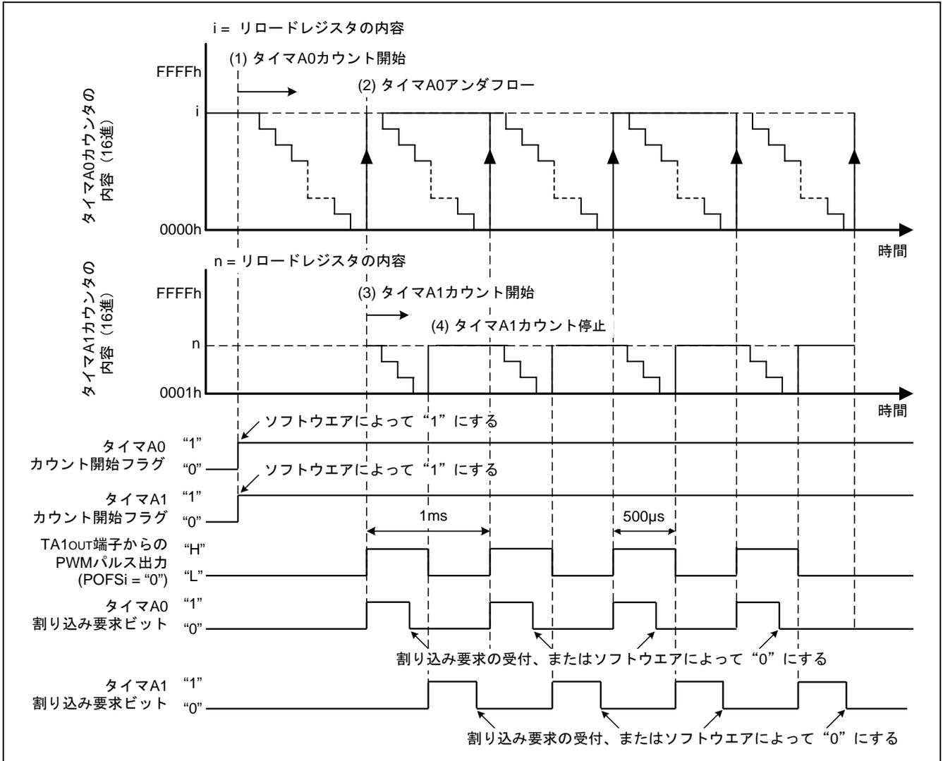
図 1. 周期およびデューティ可変の PWM 出力の動作タイミング
