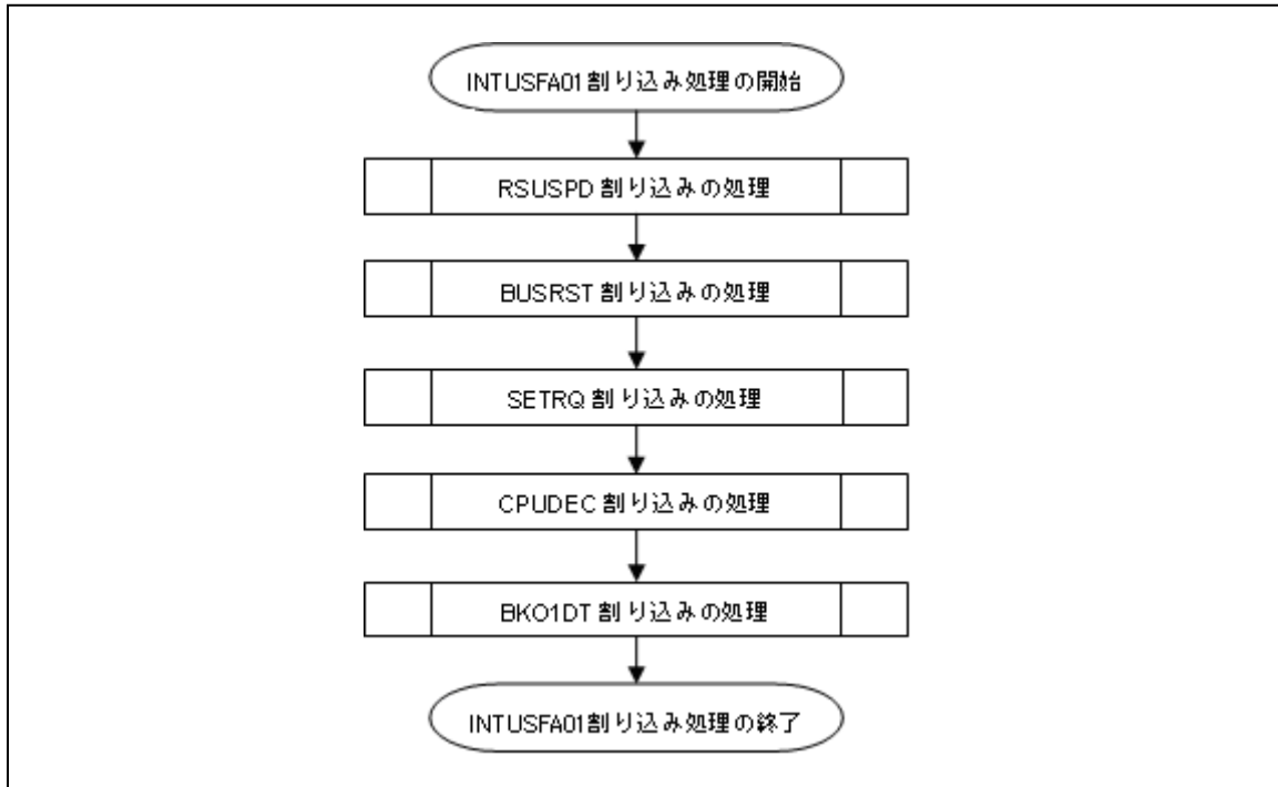
図 4-12 INTUSFA0I1 割り込みハンドラ処理フロー
