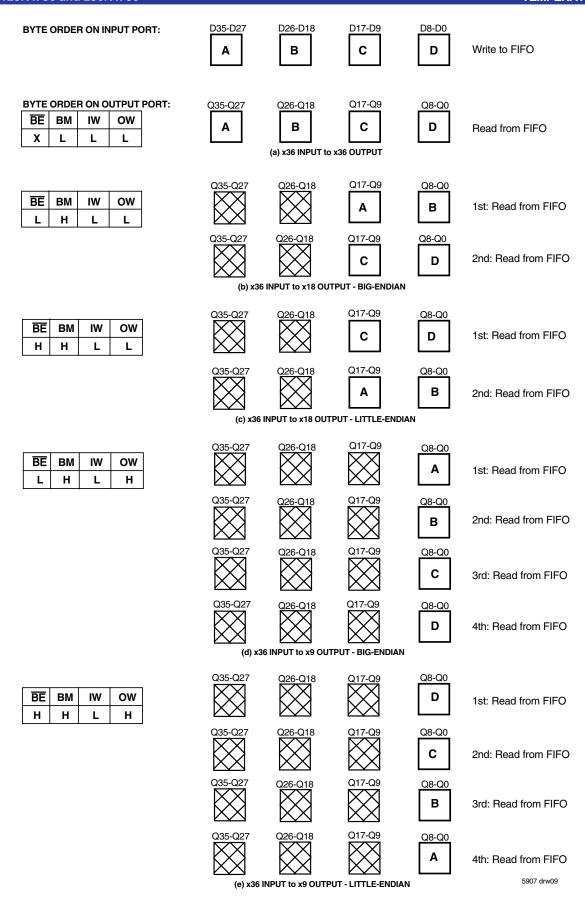
Figure 5. Bus-Matching Byte Arrangement
