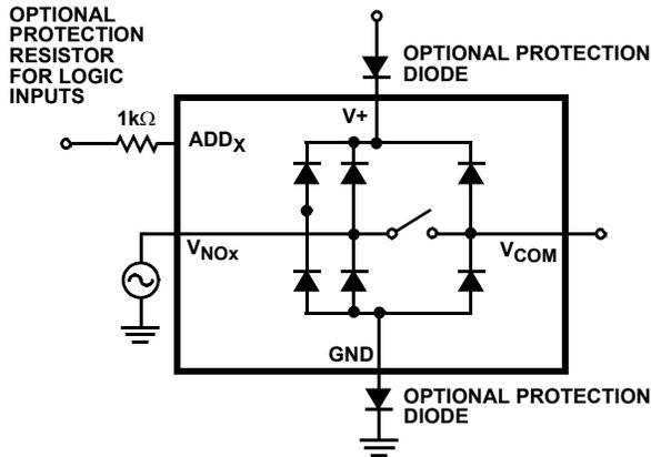
FIGURE 8. OVERVOLTAGE PROTECTION
