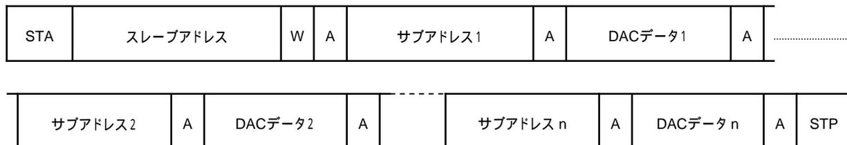
【注】 開始条件の後、スレーブアドレスによってICにアクセスし、サブアドレスとDACデータの2バイトで各チャンネルにデータ転送します。
