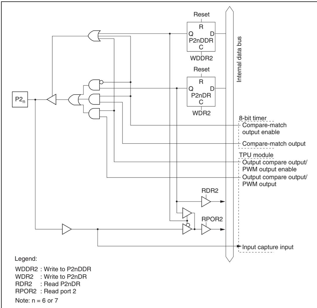
Figure C.2 (d) Port 2 Block Diagram (Pins P2<sub>6</sub> and P2<sub>7</sub>)
