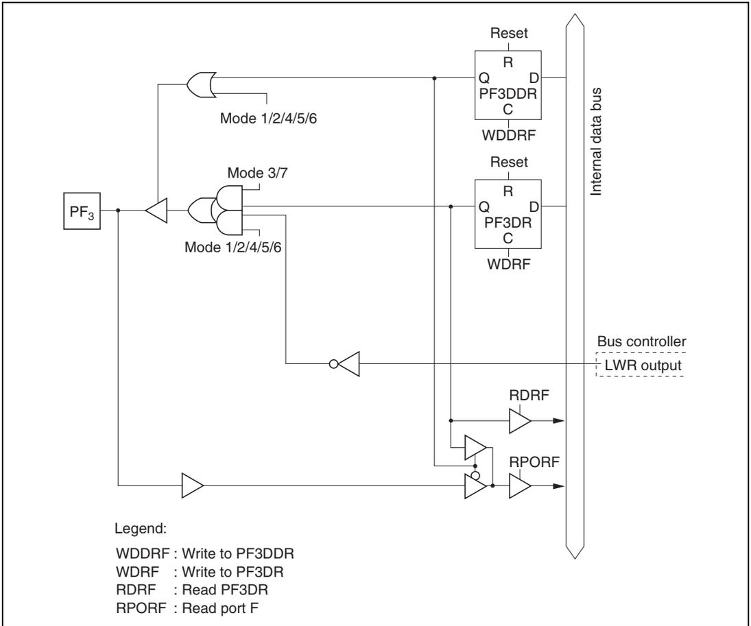
**Figure C.12 (d) Port F Block Diagram (Pin PF<sub>3</sub>)**
