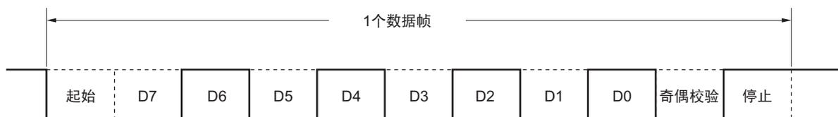
3. 数据长度：8 位、MSB 优先、奇偶校验：偶校验、停止位：1 位、通信数据：55H、TxD6 引脚取反输出
