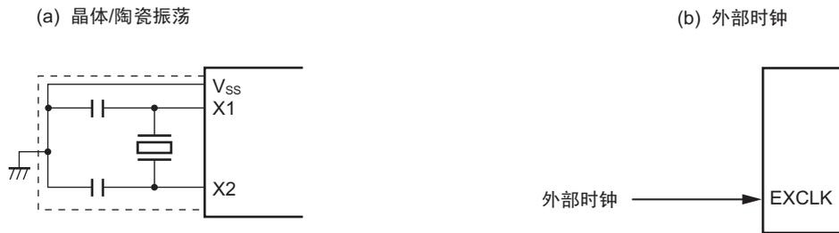
**注意** 在使用 X1 振荡电路时，对图 5-9 中虚线的部分进行如下布线，从而避免布线电容等的影响。
