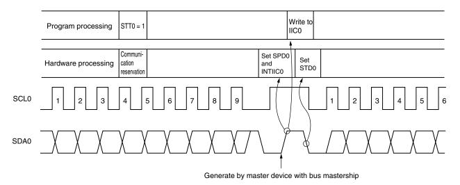
Remark IIC0: IIC shift register 0
