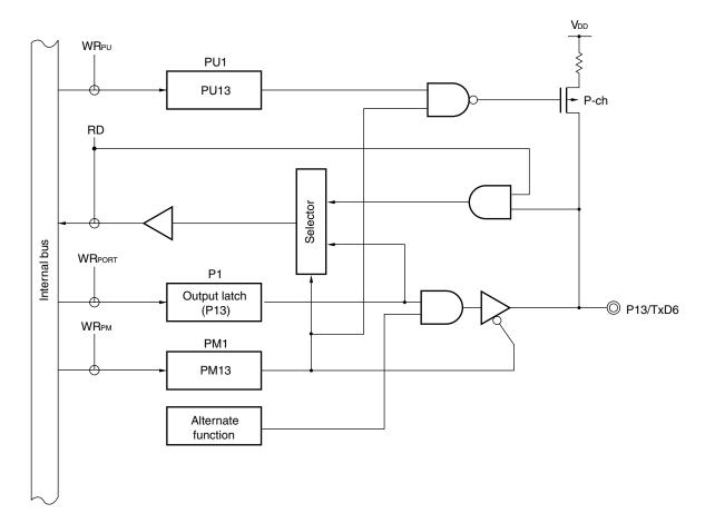
Figure 4-6. Block Diagram of P13
