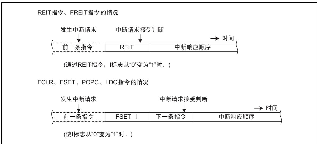
图 5.2 I标志发生变化的内容反映到中断的时序
