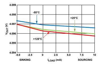
FIGURE 4. LOAD REGULATION vs  $V_{\mbox{OUT}}$  OVER TEMPERATURE
