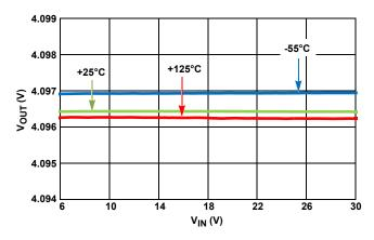
FIGURE 3. LINE REGULATION vs  $V_{\mbox{\scriptsize OUT}}$  OVER TEMPERATURE
