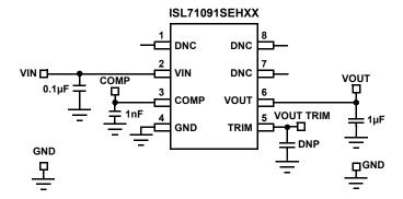
FIGURE 1. ISL71091SEHXXEV1Z BLOCK DIAGRAM
