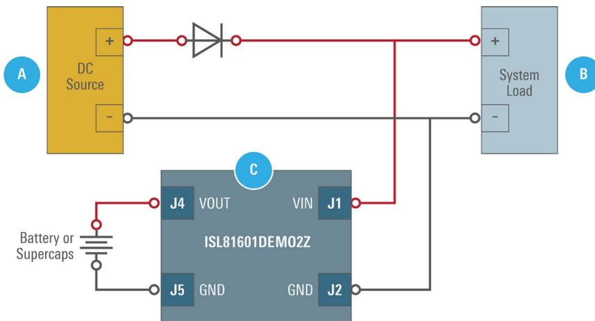
图 3. 使用双向控制器 ISL81601 的备用电池系统
