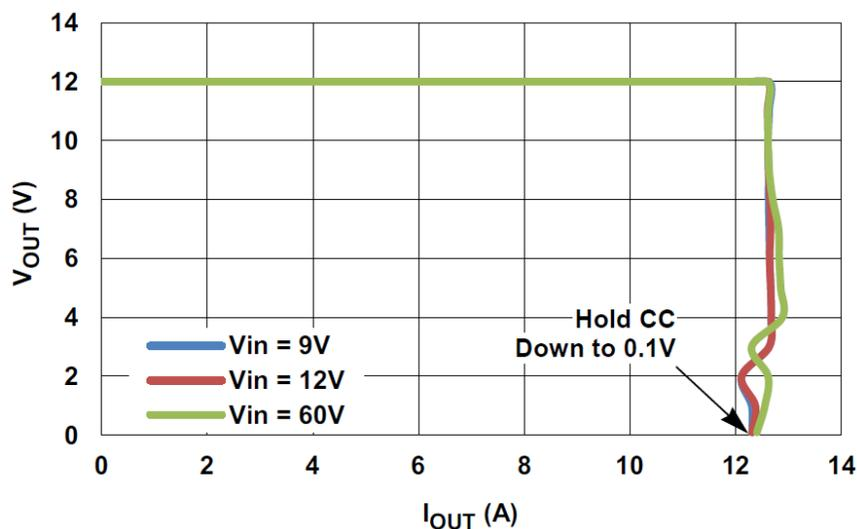
图 5.ISL81601/401 的恒定电流和恒定电压控制
