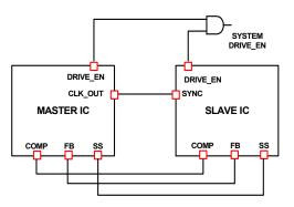
FIGURE 23. CONFIGURATIONS FOR DUAL IC OPERATION
