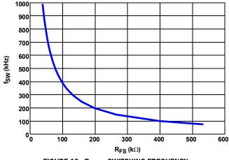
FIGURE 19. R<sub>FS</sub> vs SWITCHING FREQUENCY
