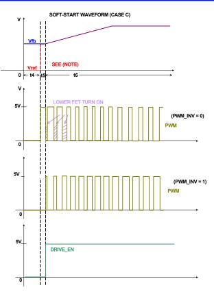
NOTE: t<sub>4</sub>, t<sub>5</sub> PERIOD ARE FROM <u>FIGURE 5</u> FIGURE 17. SOFT-START WAVEFORM (CASE C, LIGHT LOAD)
