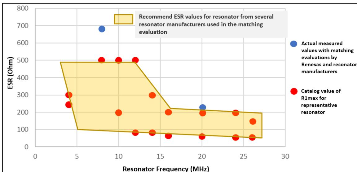
図 11 Group 6 メインクロック : Resonator Frequency vs ESR max
