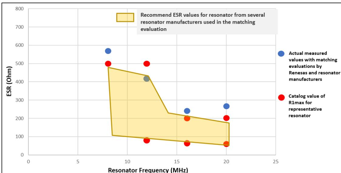
図 13 Group 7 メインクロック : Resonator Frequency vs ESR max
