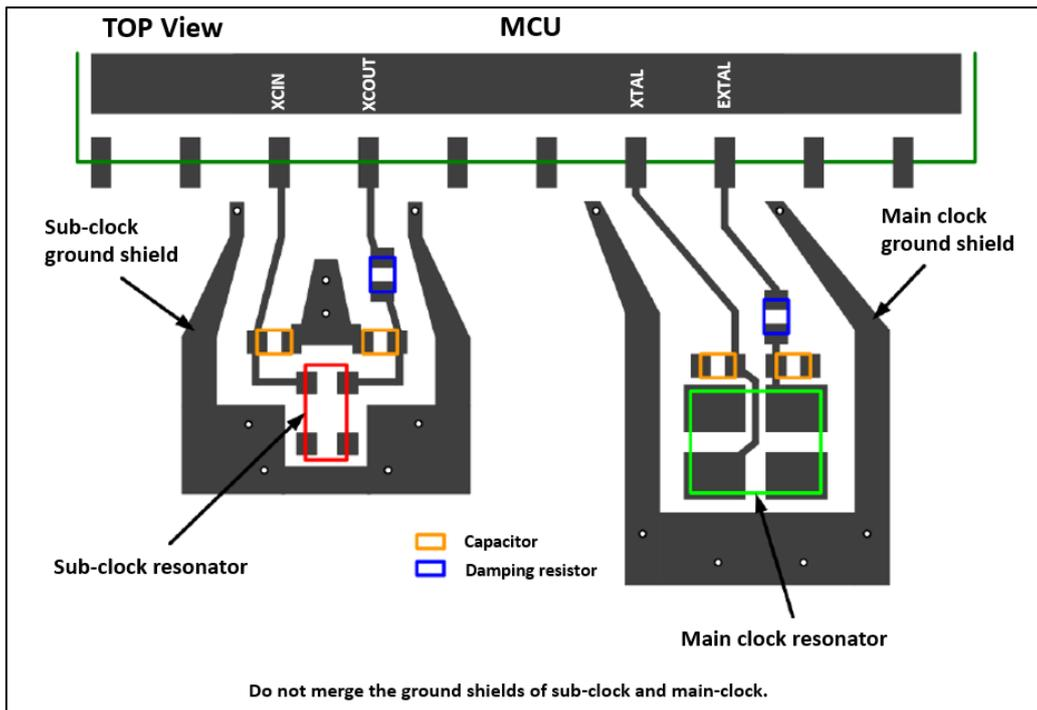
図 26 メインクロックとサブクロックのグランドシールドの配置例
