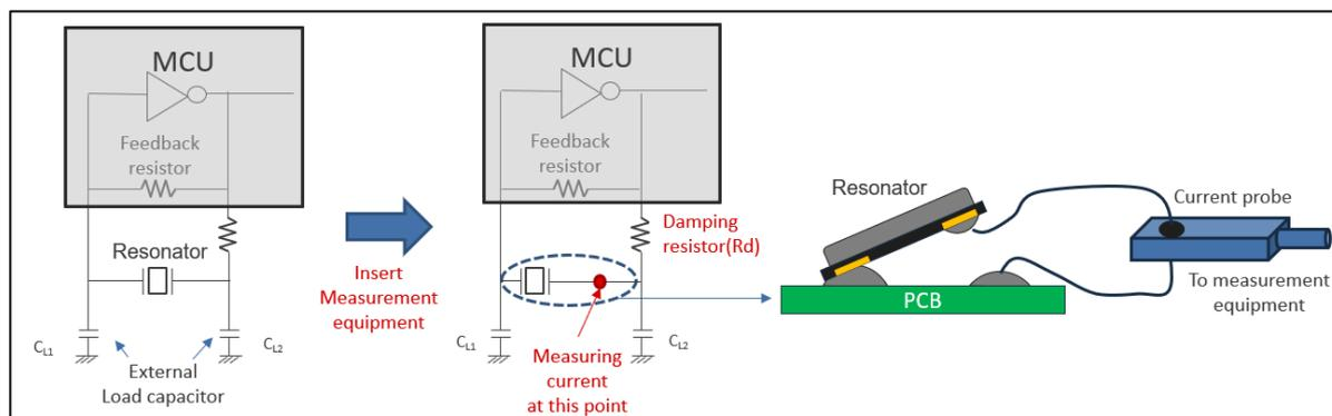
図 16 励振電力の測定方法
