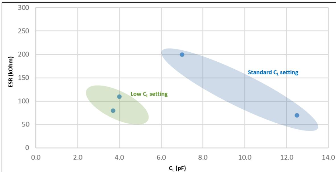
図 7 Group 3 サブクロック : C<sub>L</sub> vs ESR max
