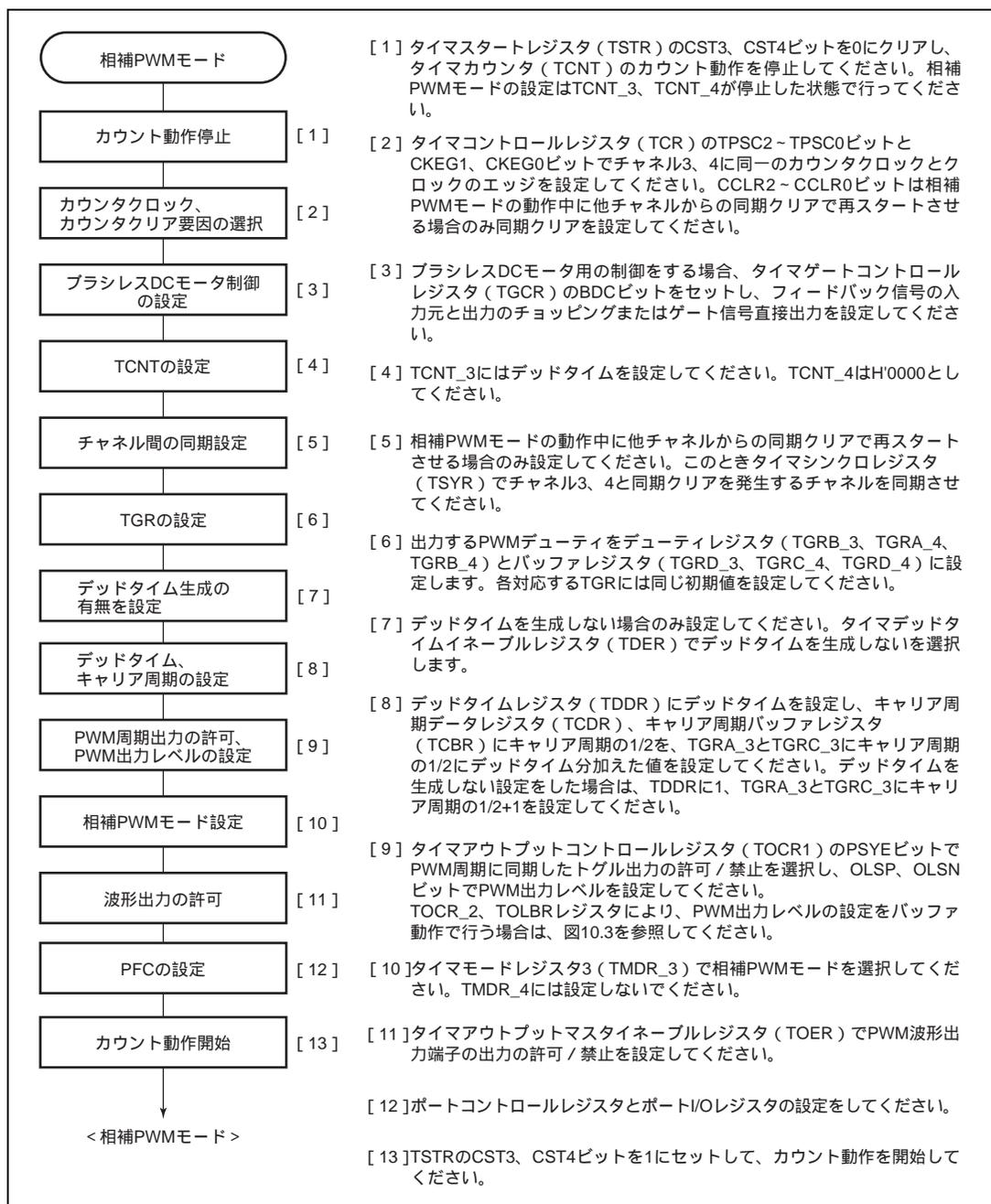
図 10.38 相補 PWM モードの設定手順例
