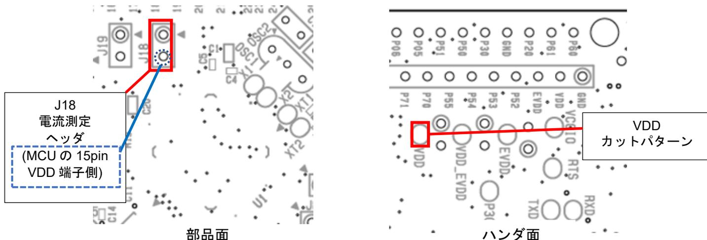
図 5-8 : J18 電流測定ヘッド および VDD カットパターン位置
