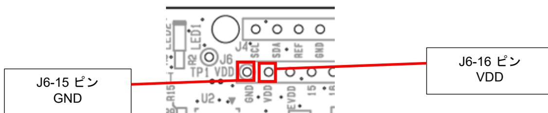
図 5-7: 外部電源供給接続先位置(部品面)
