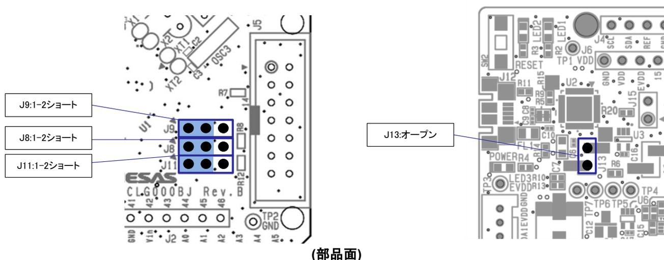
図 5-13 COM port デバッグ使用時設定
