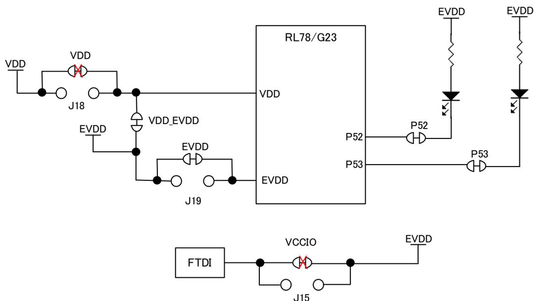
図 5-9 : 電流測定ヘッド ブロック図
