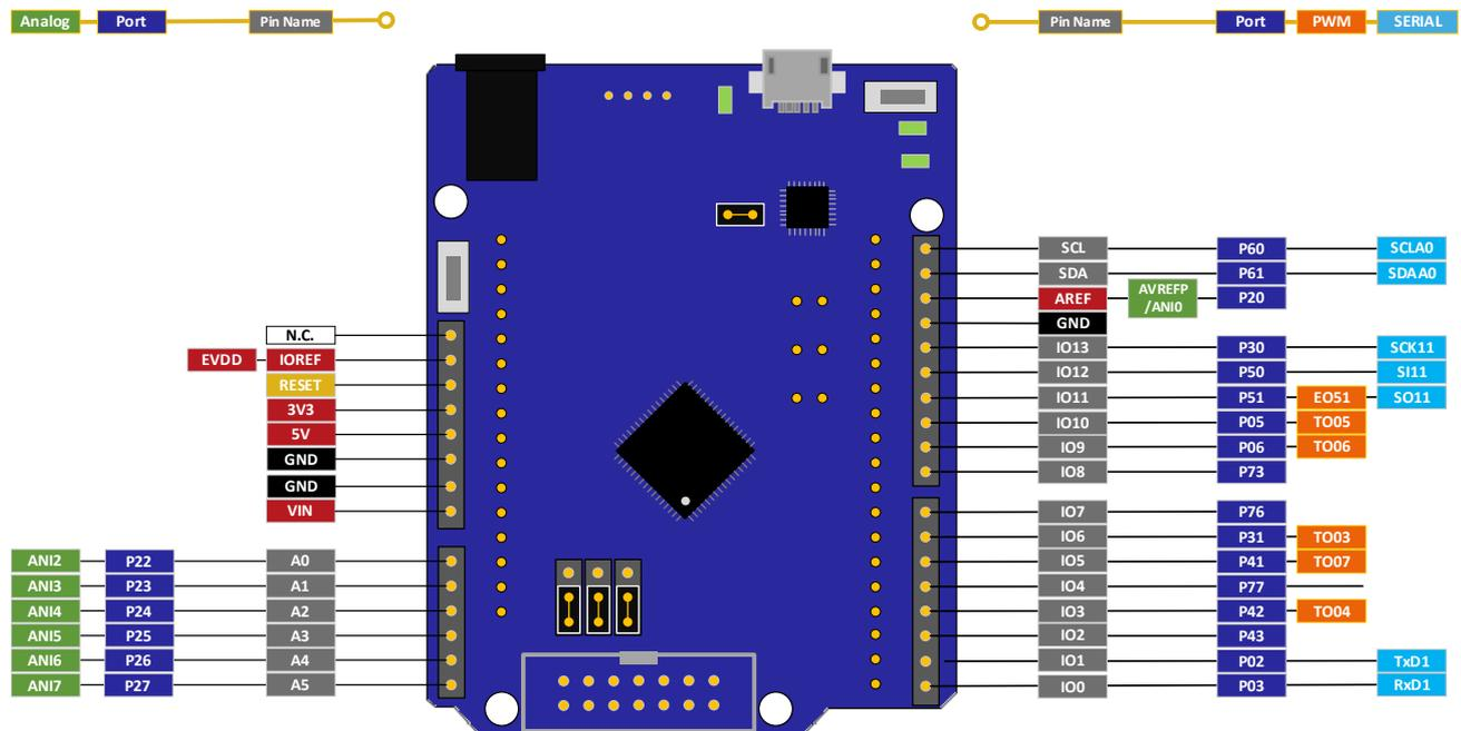
図 5-1: Arduino™ コネクタピン配置
