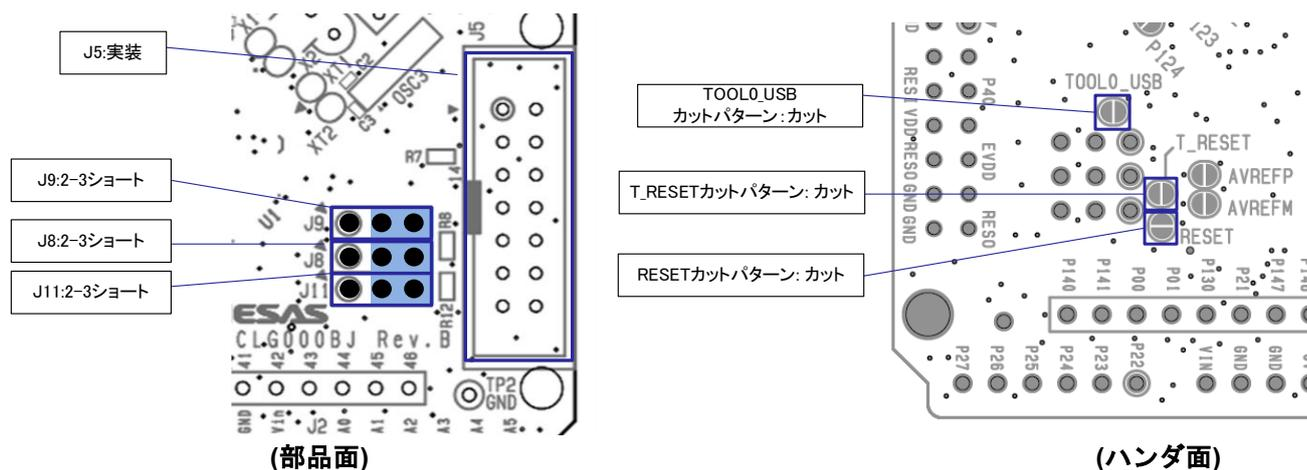
図 5-12 エミュレータコネクタ使用時設定
