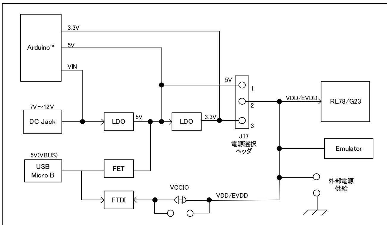
図 6-2 電源回路ブロック図
