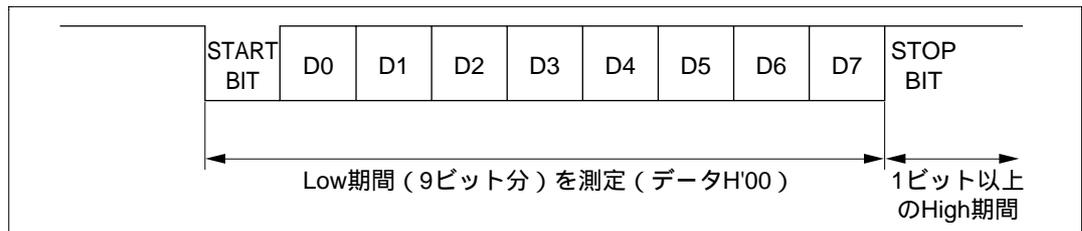
図 19.45 SCI ビットレートの自動合わせ込み動作
