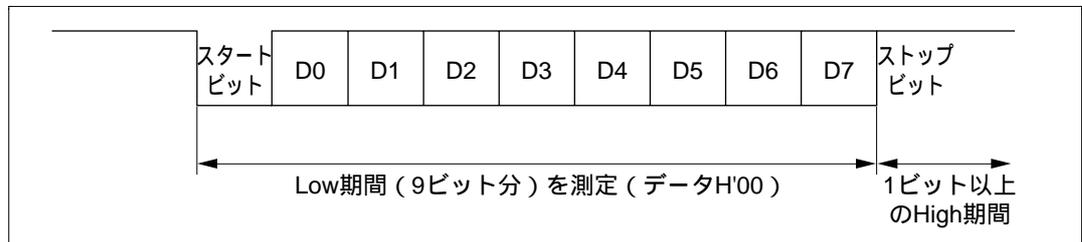
図 19.16 SCI ビットレート自動合わせ込み時の RxD1 入力信号
