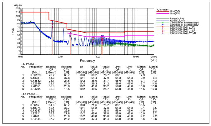
· Vin = AC120 V, 60 Hz, LED load (VF = 35 V), Iout = 220 mA
