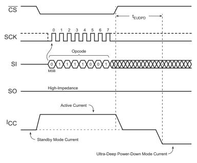
Figure 28. Entering Ultra-Deep Power-Down State
