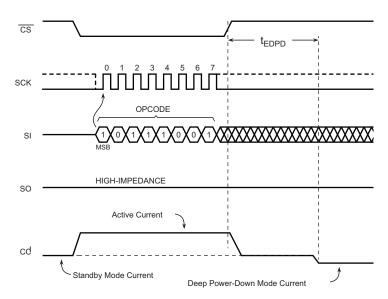
Figure 16. Deep Power-Down Timing
