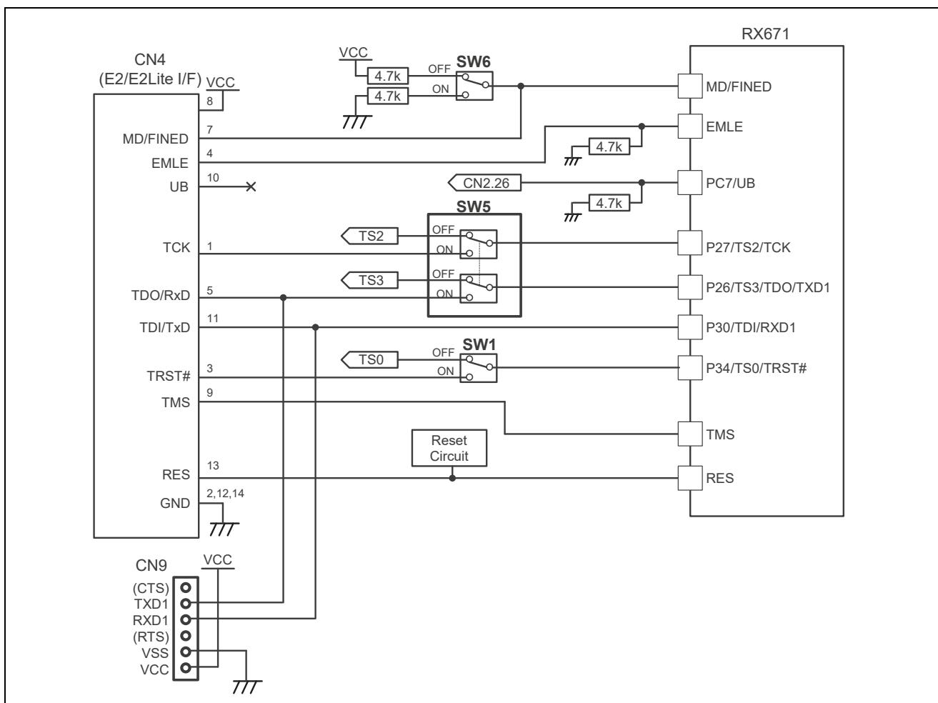
図 2-5 RX671 動作モード設定回路
