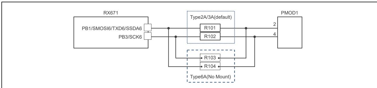
図 2-11 PMOD1 インタフェース切替え回路
