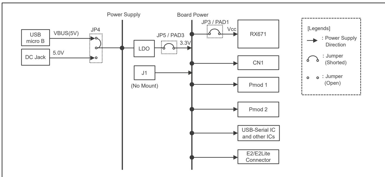
図 2-6 電源系統図
