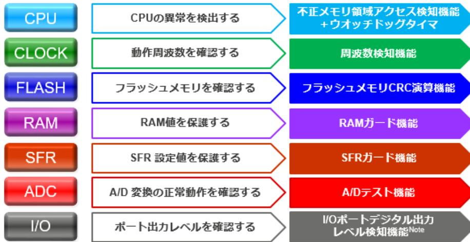
リチウムイオンバッテリーモニタ用 IC (ISL94202) が提供する安全機能
