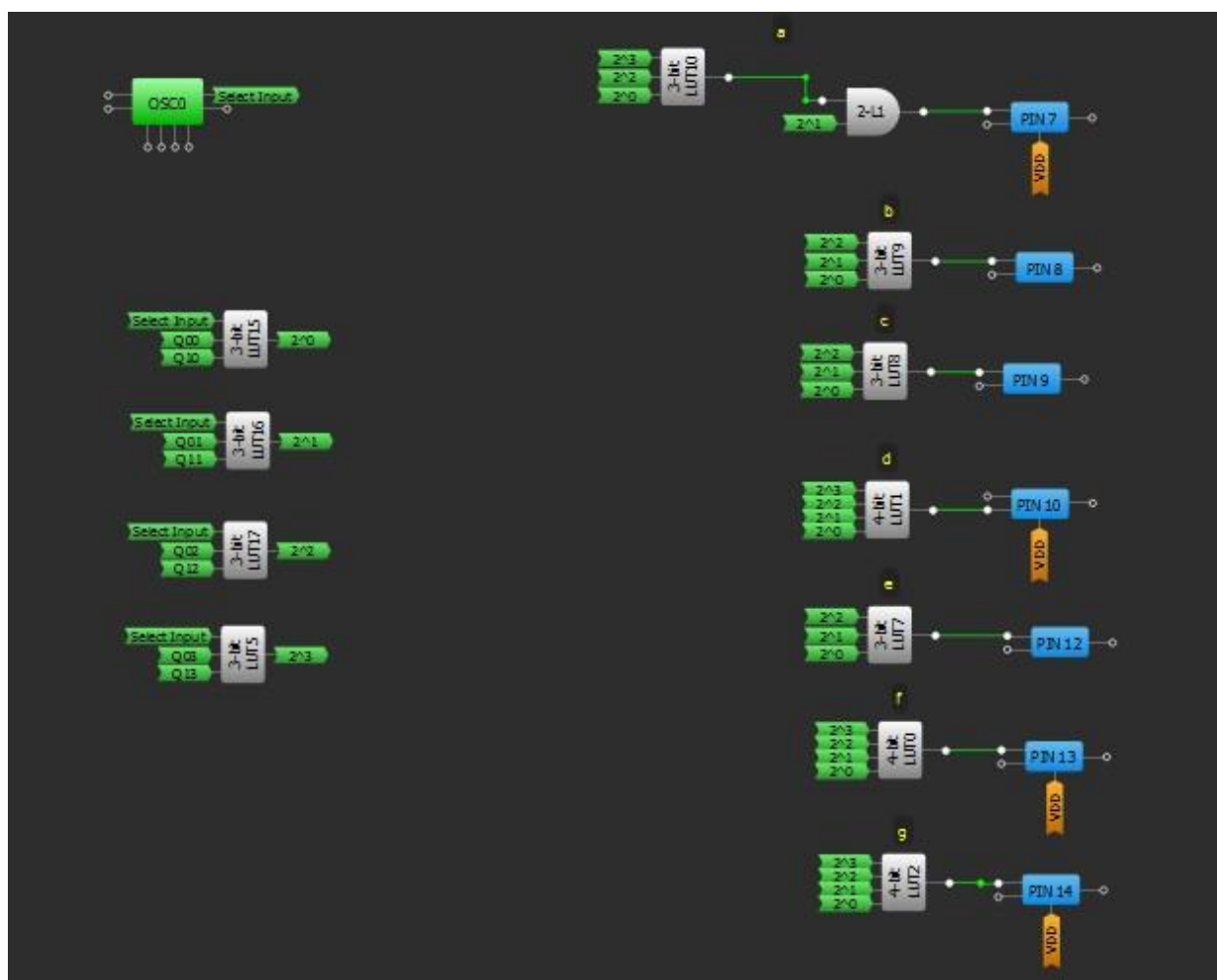
图5. BCD到7段转换器
