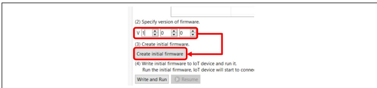
demo\_bl\_rx65n\_ck\_primary プロジェクトと demo\_rx65n\_ck\_primary プロジェクトのビルドが実行され、「Initial Firmware」タブに「Create firmware is complete.」と表示されれば成功です。
