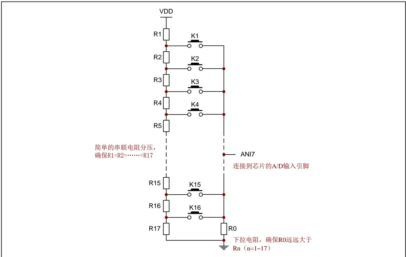
图 5.1 A/D 按键输入的硬件配置示例
