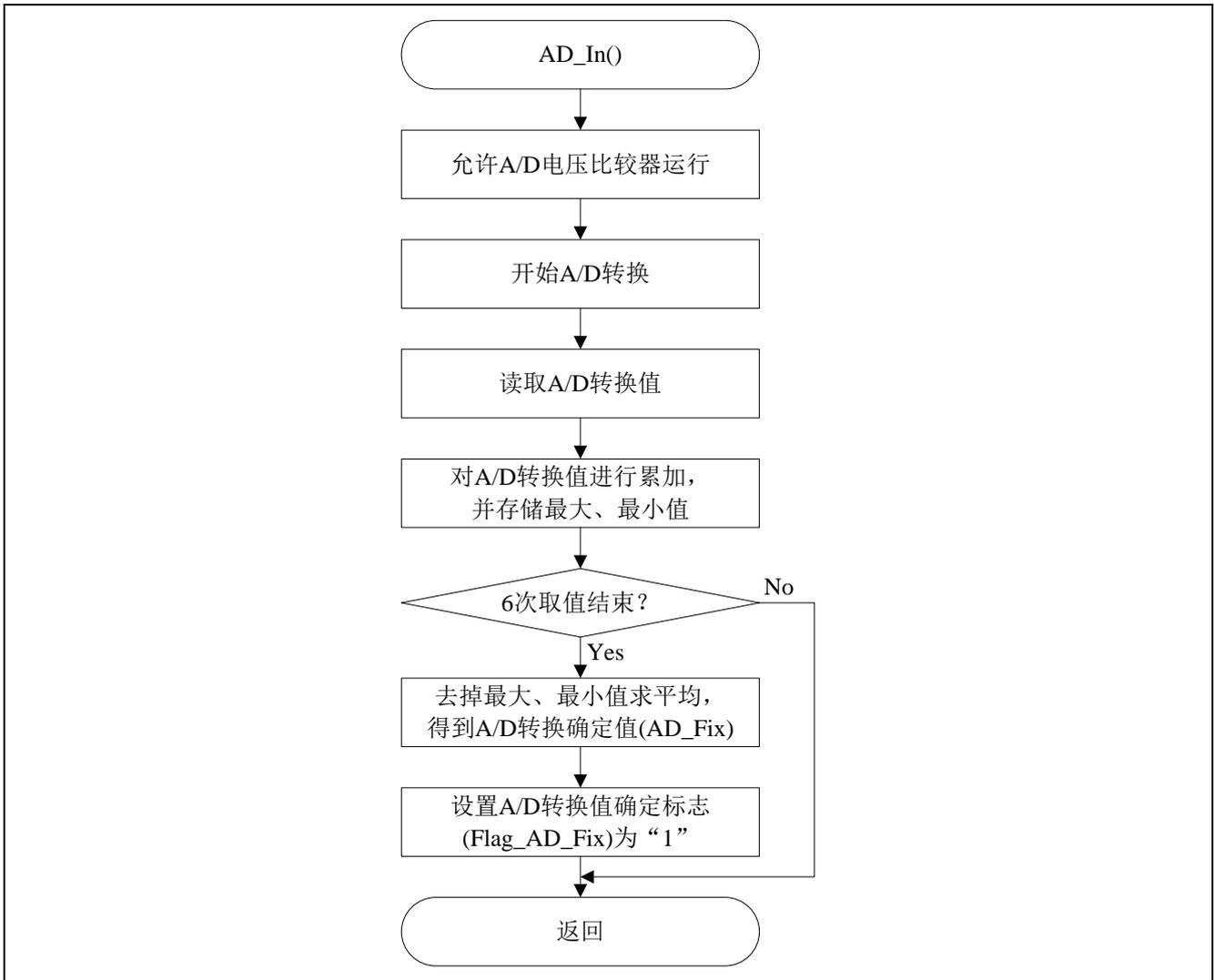
图 5.14 A/D 转换、确认 A/D 值处理
