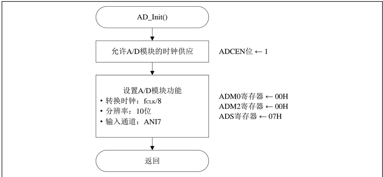
图 5.8 A/D 转换器功能初始化设置
