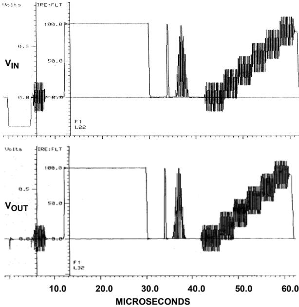
FIGURE 2. COMPOSITE VIDEO INPUT AND SYNC STRIPPER OUTPUT
