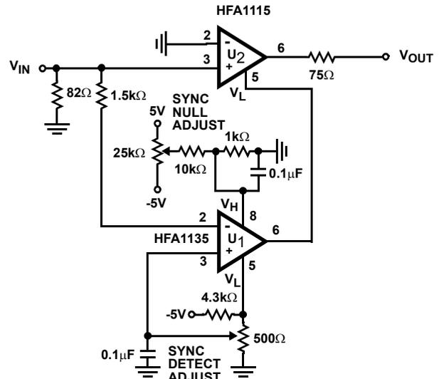
FIGURE 1. COMPOSITE VIDEO SYNC STRIPPER
