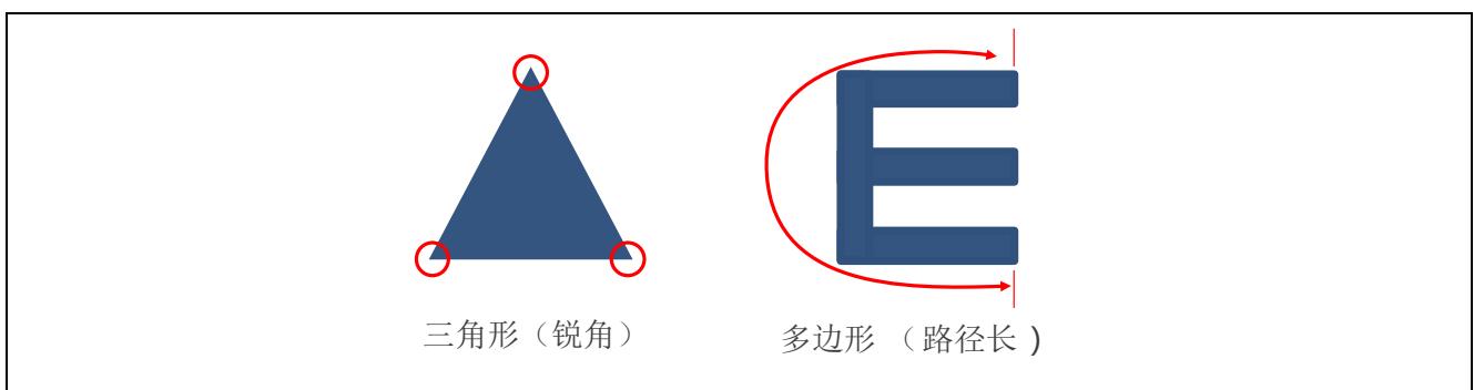
图 2-8. 不合适的电极形状
