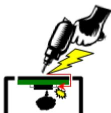
图 5.2 静电通过面板间隙对电极放电的示例
