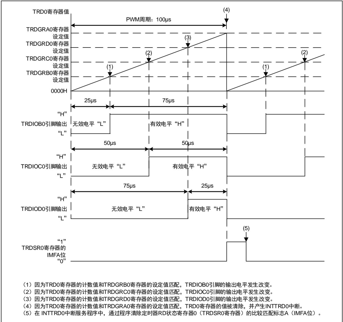
图 4.1 PWM 输出波形
