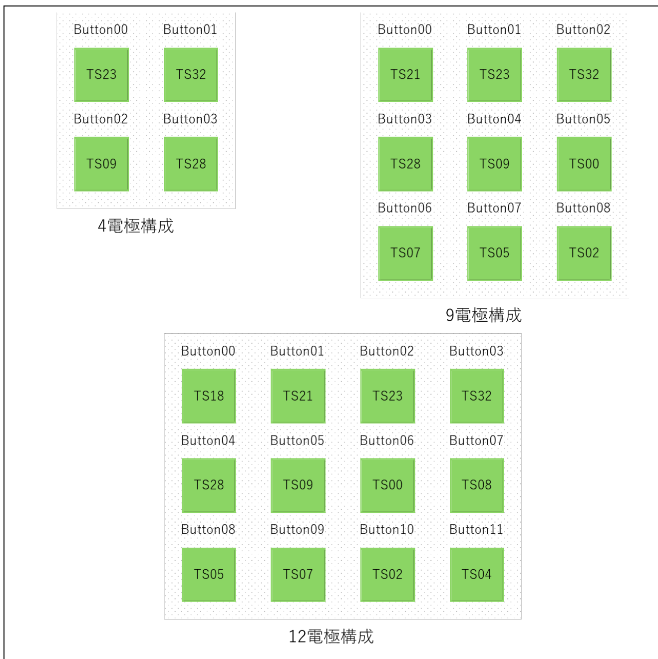
図 5.2 タッチインタフェース構成
