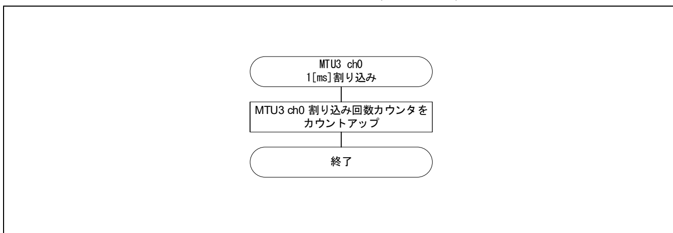
図 3-15 マルチファンクションタイマパルスユニット 3 (チャンネル 0) 1 [ms]割り込み処理フローチャート
