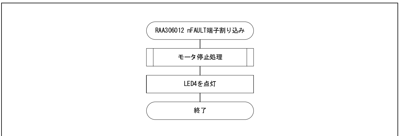
図 3-16 RAA306012 nFAULT 端子割り込み処理フローチャート
