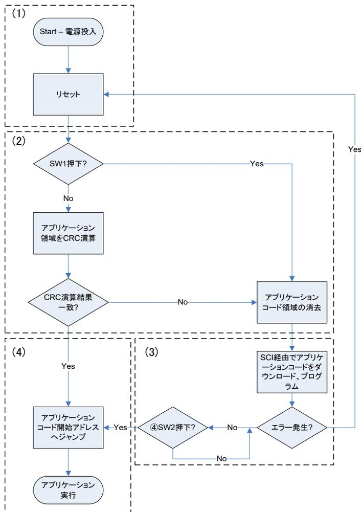
図 3-2: ブートローダ動作フロー
