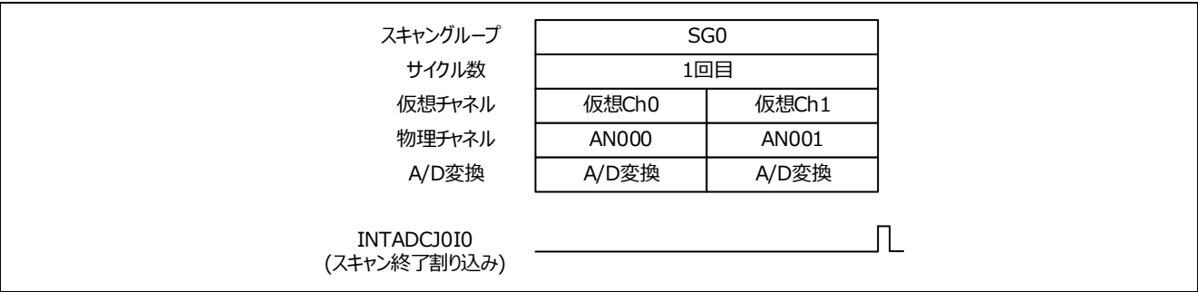
図 3.1.1 通常 A/D 変換（マルチスキャン）動作
