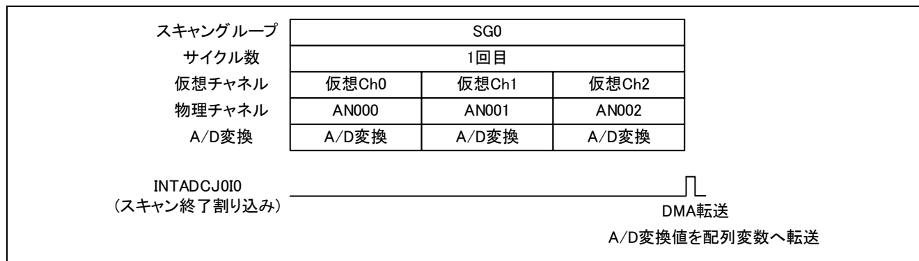
図 3.7.1 DMA 転送を使用した動作例
