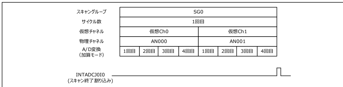
図 3.4.1 加算モードを使用した通常 A/D 変換動作
