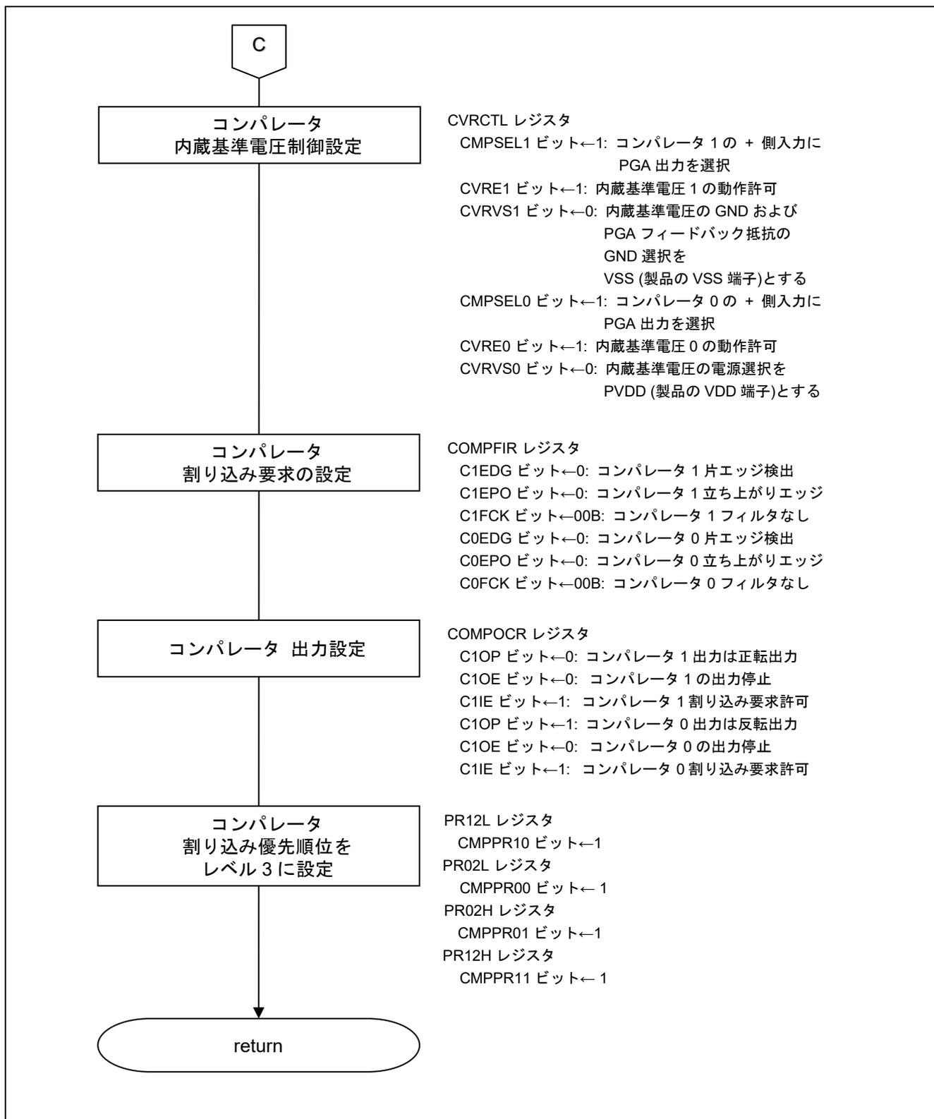
図 4.21 コンパレータ・PGA 初期設定(2/2)
