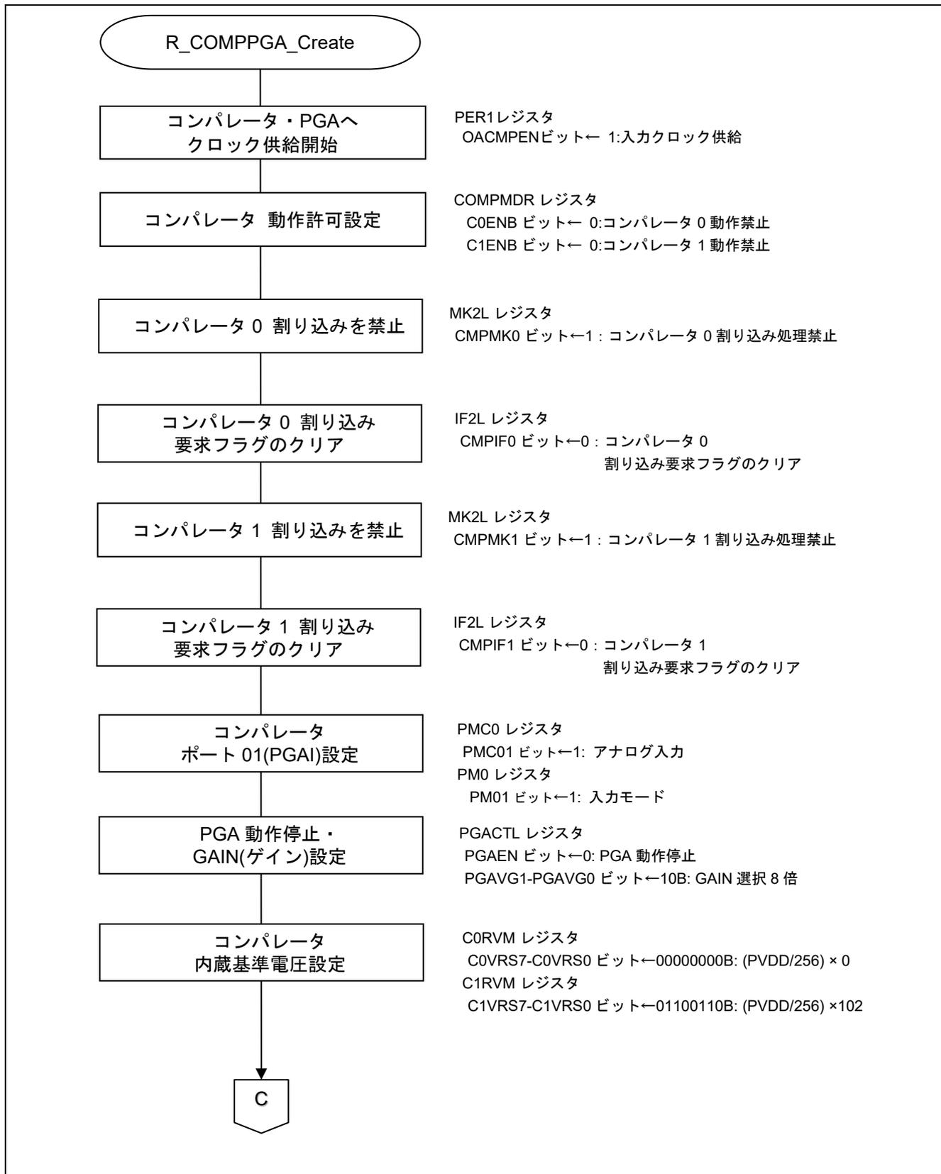
図 4.20 コンパレータ・PGA 初期設定(1/2)
