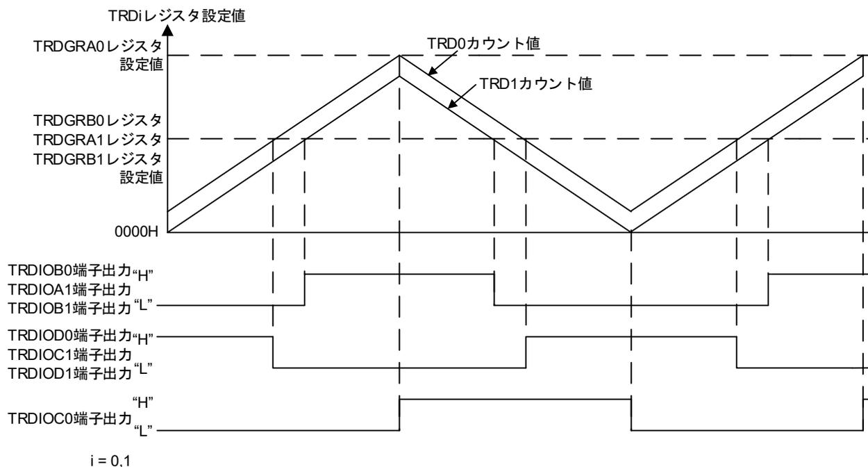
図 1.3 相補 PWM の出力波形
