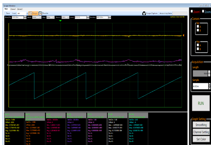
図 5-3 TAS2143 を使用した速度制御波形
