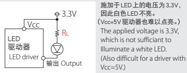
图 2 Vcc=3.3V、耐压 24V 的驱动器
