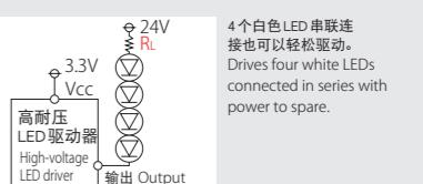
Vf:一般红色、绿色、黄色 LED 的 Vf 在 1.8V 左右，蓝色、白色在 3 ~ 3.6V 左右。红外 LED 在 1.3V 左右。
