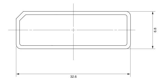
MP115 - 01A length : 5152.0 thickness : 0.7  $^{+0.3}_{-0.2}$  tolerance : 0.4
