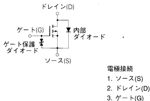
本製品のゲート・ソース間に内蔵されている保護ダイオードは取り扱い時における静電気保護用です。実使用回路において、ゲート・ソース間に過大な電圧が印加されるおそれのある場合には保護回路をつけてご使用ください。
