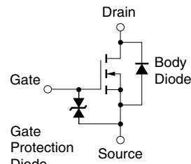
備考 本製品のゲート-ソース間に内蔵されている保護ダイオードは、取り扱い時における静電気保護用です。実使用回路において、ゲート-ソース間に過大な電圧が印加される恐れがある場合には、保護回路をつけてご使用ください。
