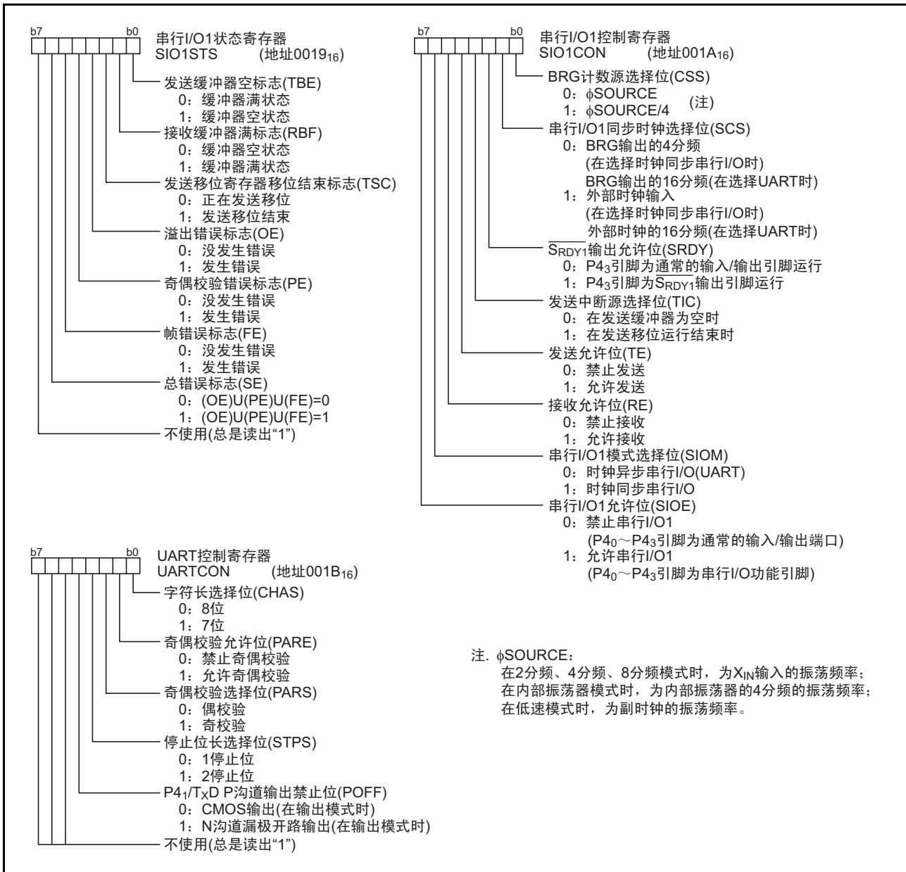
图 37 串行 I/O1 的关联寄存器的结构
