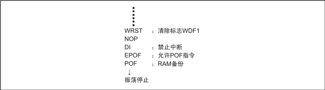
图 FB-10 使用看门狗定时器时的程序例子
