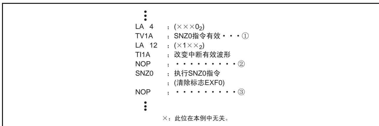
图 31 外部 0 中断程序例子 3
