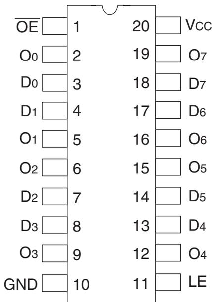
CERDIP/ SOIC/ SSOP/ QSOP
