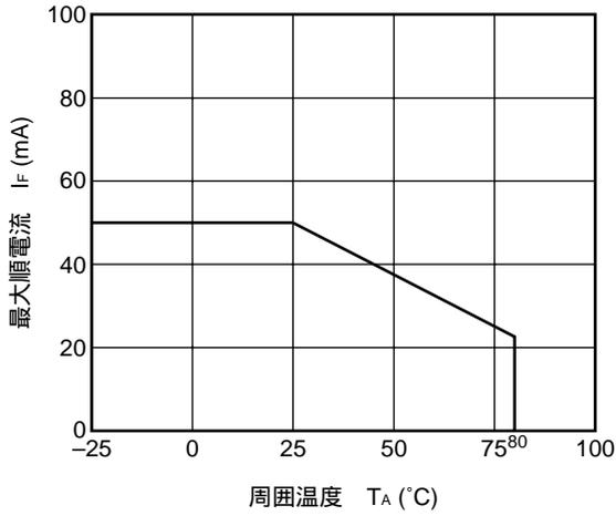
最大負荷電流 vs. 周囲温度
