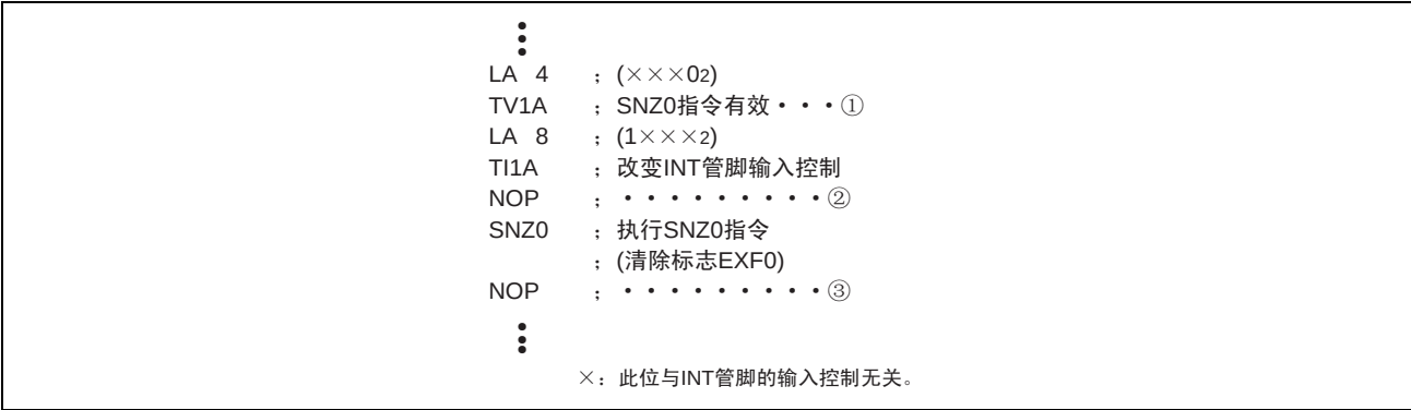
图 DD-6 外部 0 中断程序例子 1
