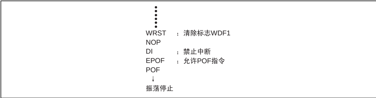
图 FB-9 转移到使用监视定时器时的模式的程序例子
