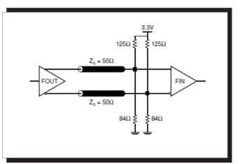
FIGURE 3B. LVPECL OUTPUT TERMINATION
