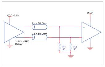
FIGURE 4C. 2.5V LVPECL TERMINATION EXAMPLE
