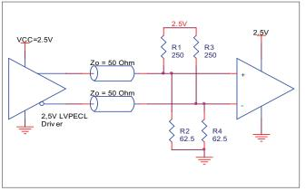
FIGURE 4A. 2.5V LVPECL DRIVER TERMINATION EXAMPLE
