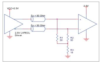
FIGURE 4B. 2.5V LVPECL DRIVER TERMINATION EXAMPLE
