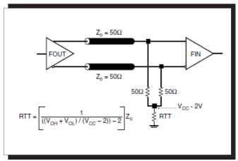
FIGURE 3A. LVPECL OUTPUT TERMINATION
