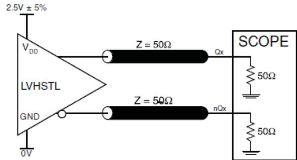
2.5V CORE/2.5V OUTPUT LOAD AC TEST CIRCUIT
