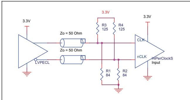
**FIGURE 3C. CLK/nCLK INPUT DRIVEN BY 3.3V LVPECL DRIVER**
